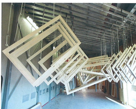
/ Großzügig bemessen ist die Trockenzone der Oberflächenanlage. Sie bietet reichlich Platz auch für große Bauteile mit Abmessungen von bis zu 6 x 3,2 m.
