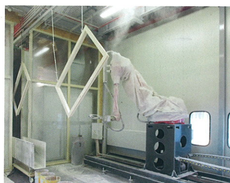
/ Der Roboter greift auf die beim Scannen exakt erfasste Teilegeometrie zurück. Luftbefeuchtung sorgt für gleichbleibend sehr gute Oberflächenergebnisse.
