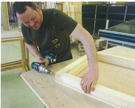
Ganz ohne Rahmenpresse werden die Teile beieimt und dann die Fensterecke verschraubt. Die Schraube hat keine statische Funktion, sie fixiert lediglich.
