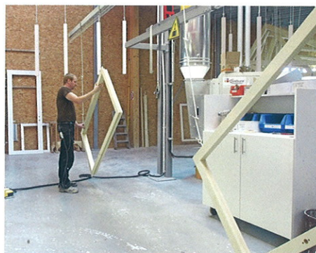
/ Bedacht und gemacht: Das Aufhängen der Flügel und Rahmen erfolgt – ergonomisch vorteilhaft – an der integrierten Absenkstation der Finiture-Anlage.
