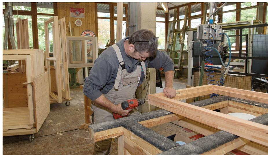
... und anschließend mit Hilfe von Schrauben verpresst.
