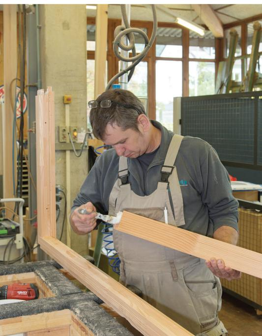
Am Arbeitstisch direkt am Auslauf der Conturex werden die Kanteln beilimt und von Hand zusammengesteckt ...
