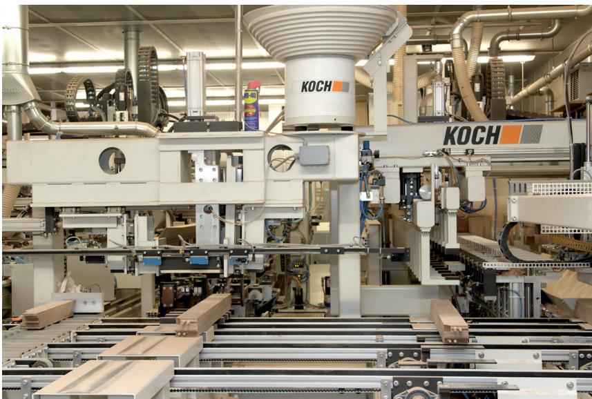
*Im dritten Modul der Anlage, der Koch WinDoor-LU, erfolgt das längenunabhängige Bohren und Dübeln der Kanteln.*
