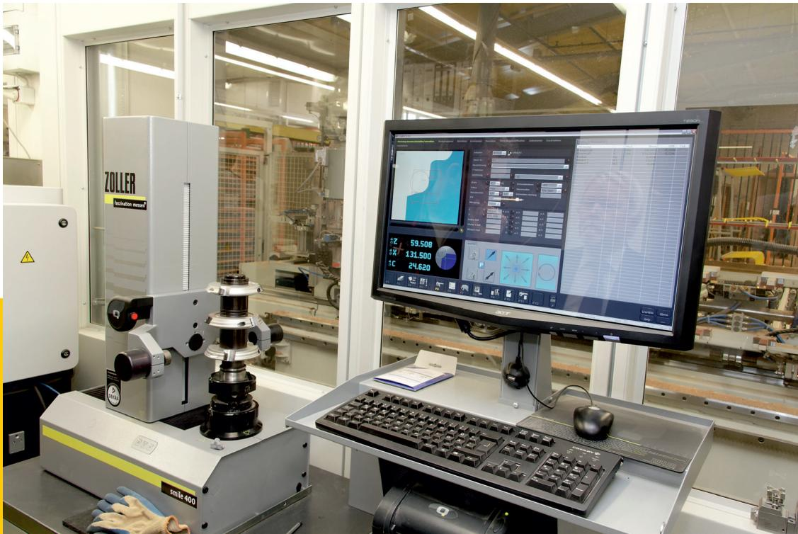
Die U-förmige Anlage umschließt den Fertigungsleitstand. Dort sind auch die Werkzeugpflege und das moderne Werkzeugvermessungsgerät untergebracht.
